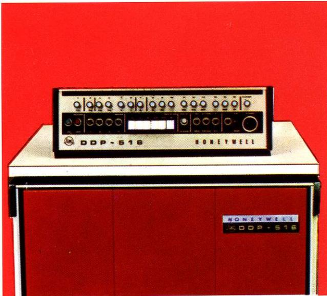
Das Programmierpult des DDP-516 ist durch ein 3 m langes Kabel mit der Zentraleinheit verbunden und kann so aufgestellt werden, daß der Bediener bequem Zugang zur Konsole hat.
