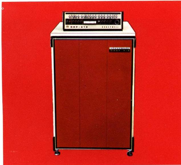
Der DDP-516 ist ein preiswerter und dabei leistungsstarker 16-Bit-Vielzweckrechner. Die Kernspeicherkapazität beträgt in der Standardausführung 4096 Worte (ausbaufähig bis auf 32 768 Worte) mit einer Zykluszeit von 0,96  $\mu$ s. Äußerst hohe Rechen- und Ein/Ausgabegeschwindigkeiten machen den DDP-516 zu einem idealen Instrument für die Bearbeitung von Echtzeitproblemen in „on-line-Systemen.“
