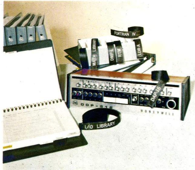
RTM besteht aus einer Reihe integrierter Programme, die folgende Funktionen haben: (1) Durchführung der Planungs- und Steuerungsaufgaben, die für einen koordinierten Ablauf der einzelnen, gemeinsam im Rechner laufenden Programme erforderlich sind; (2) Registrierung aller auftretenden Vorrangunterbrechungen, damit eine Weiterverarbeitung erfolgen kann, und (3) Steuerung und Durchführung aller Ein-/Ausgabeoperationen.
